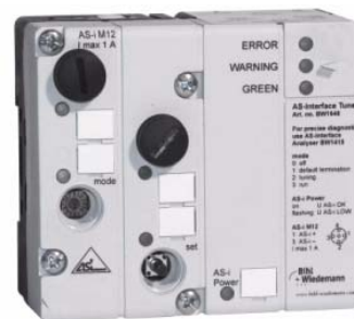
Terminaison de bus AS-i (Valeur par défaut du tuner AS-i)
